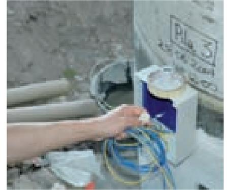
Per il controllo nel tempo delle performance strutturali del ponte, si sono utilizzate due nuove tipologie di sensore di deformazione, messe a punto dal Consorzio Cetma, dall'Enea e da ATP Pultrusion, e basate sull'integrazione della tecnologia delle fibre ottiche con quella degli FRP. Si tratta, infatti, di due sistemi "smart", costituiti da una struttura in FRP
